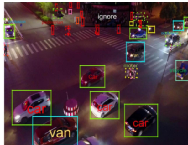
基于无人机视觉平台的目标识别 (YOLO算法)
